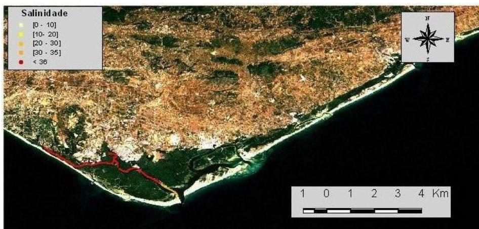
**Figura 51** Salinidade ao longo dos canais principais da Ria Formosa em agosto de 2005, obtida com sonda multiparamétrica YSI 6600 EDS a bordo de uma embarcação
