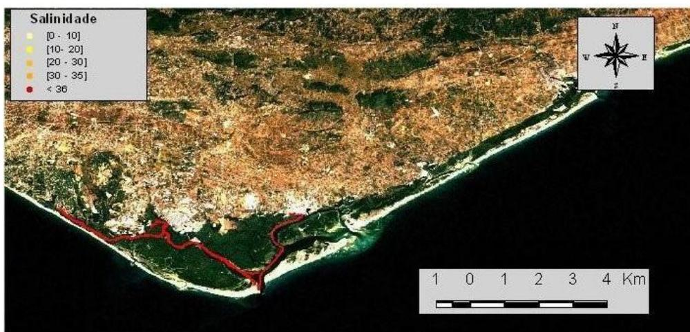
**Figura 50** Salinidade ao longo dos canais principais da Ria Formosa em maio de 2005, obtida com sonda multiparamétrica YSI 6600 EDS a bordo de uma embarcação
